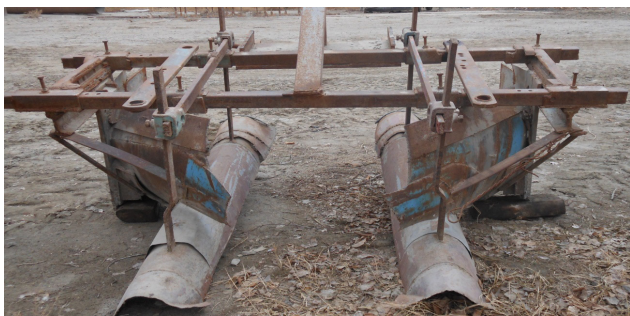
ПСУЕАИТИ Бухоро ИТС олимлари томонидан яратилган шўр ювишдан олдин ва ўсимликнинг вегетация даврида, 1-суғоришдан олдин ўсимликка зарар бермасдан қатор орасига марза(чел) олувчи қурилма ихтироси
