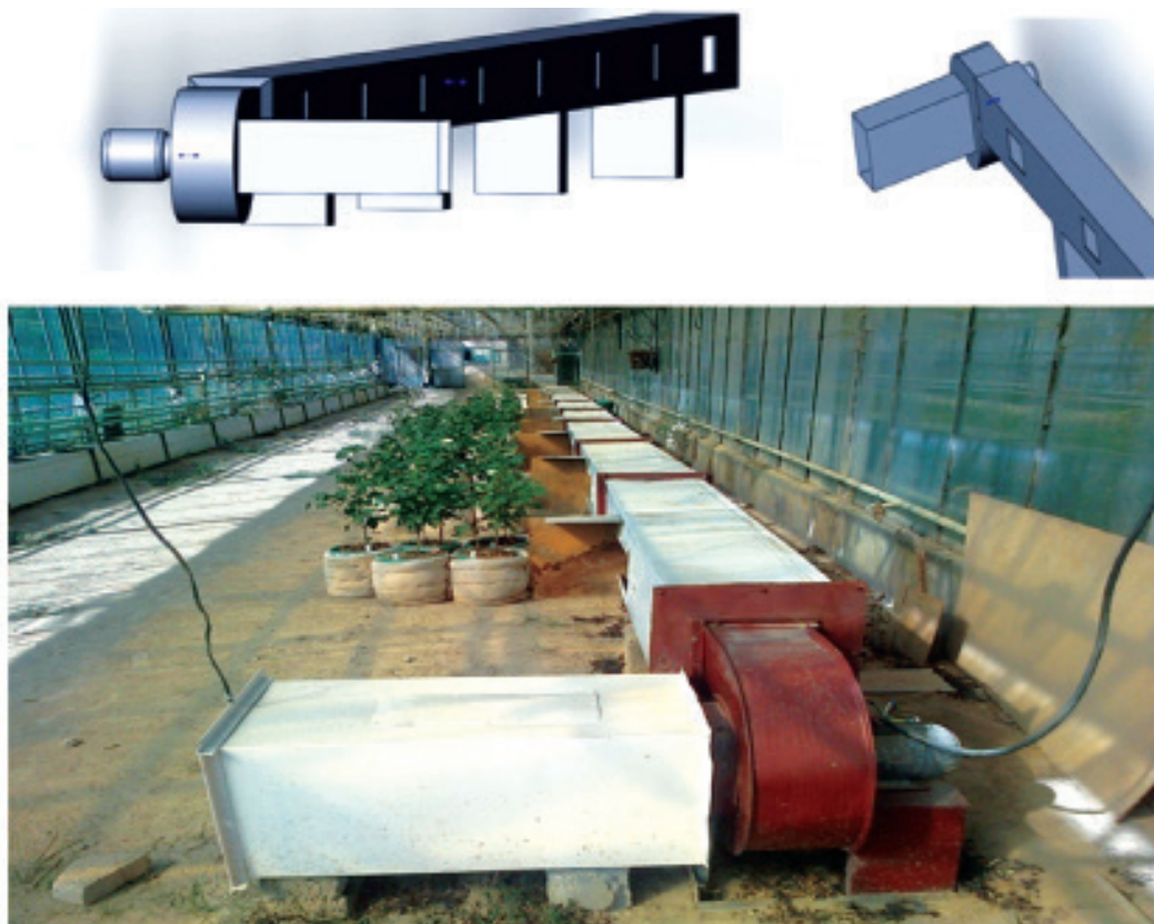
Рис. 2. Приспособление для искусственного гармселя и вид опыта.
