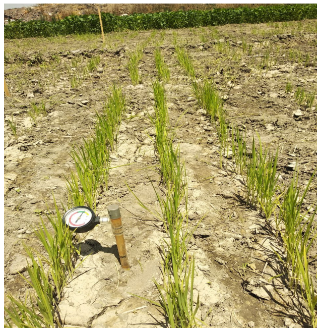
Расм 1. Тажриба майдонига ўрнатилган тензиометр асбоби.
