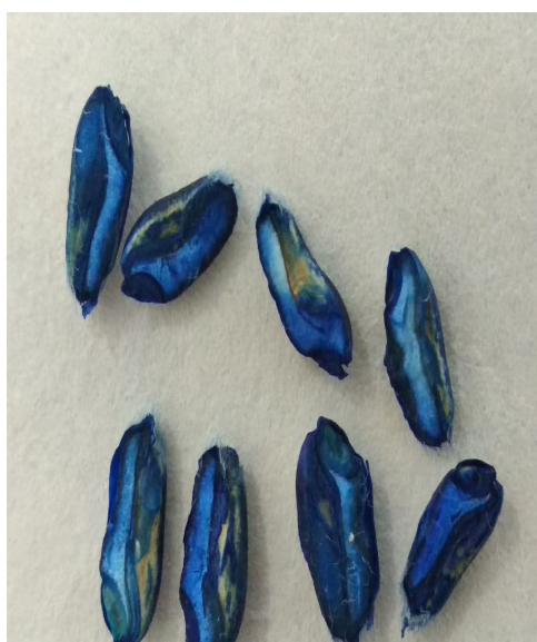
Расм. Уруғларнинг ҳаётчанлигини тезкор тетразол усули (тетразол моддаси аналогси фуксин моддаси) билан аниқлаш жараёни.
